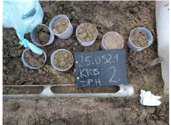
Bild 8: Ludwigshafen, NBG Frankenthaler Straße, SCH 2, Detailansicht: Bohrgut in Dosen und Schoppen
