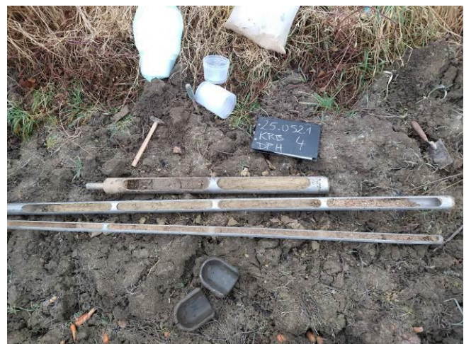
Bild 12: Ludwigshafen, NBG Frankenthaler Straße, SCH 4, Detailansicht: Bohrgut in Schoppen
