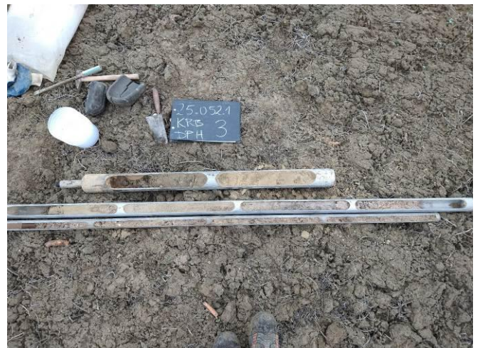
Bild 10: Ludwigshafen, NBG Frankenthaler Straße, SCH 3, Detailansicht: Bohrgut in Schoppen
